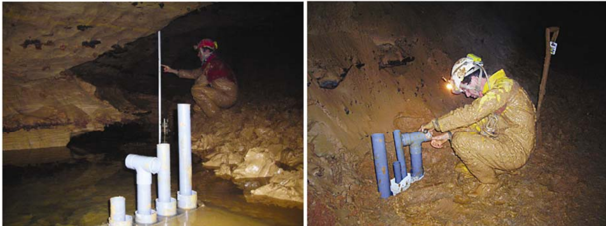
Figure 54 - Vue en coupe des deux pièges multi-trappes à sédiments. Système de tubes emboîtés, scellés à un parpaing. Le "T" supérieur doit permettre de créer un effet « venturi » afin de concentrer les sédiments en suspension. Photo gauche : installation d'un PMTS dans la rivière des Bélemnites. Au second plan de la photographie le LUIROGRAPHE émergé à 55 cm. (cliché : G. Dandurand, le 04/08/2009). Photo droite : installation d'un PMTS au puits d'entrée n° 2 (Cliché N. Frisch, le 04/08/2009).
