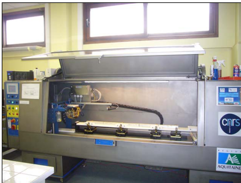
Photo 4 - Vue de l'Aavatech XRF Core Scanner du laboratoire EPOC (Bordeaux, I. Billy et P. Martinez) qui permet des analyses automatisées de la composition chimique de longues séries sédimentaires (Cliché Lab. EPOC).
