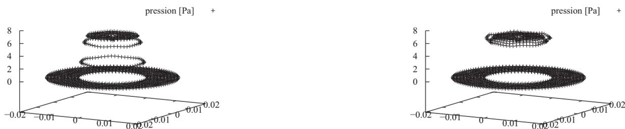
FIGURE 4.68 – Champ de pression pour le cas d'une goutte sphérique - modèle SDSCSF - sans saut de pression (gauche) et avec saut de pression (droite)
