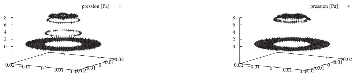
FIGURE 4.67 – Champ de pression pour le cas d'une goutte sphérique - modèle DSCSF - sans saut de pression (gauche) et avec saut de pression (droite)
