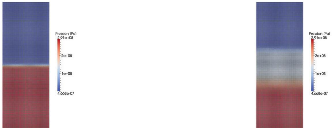
FIGURE 4.32 – Évolution de la pression cas du tube à choc - cas 2D - Initiale à gauche et finale à droite
