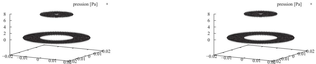
FIGURE 4.69 – Champ de pression pour le cas d’une goutte sphérique - modèle LLPC - modèle de courbure volumique (gauche) et analytique (droite)
