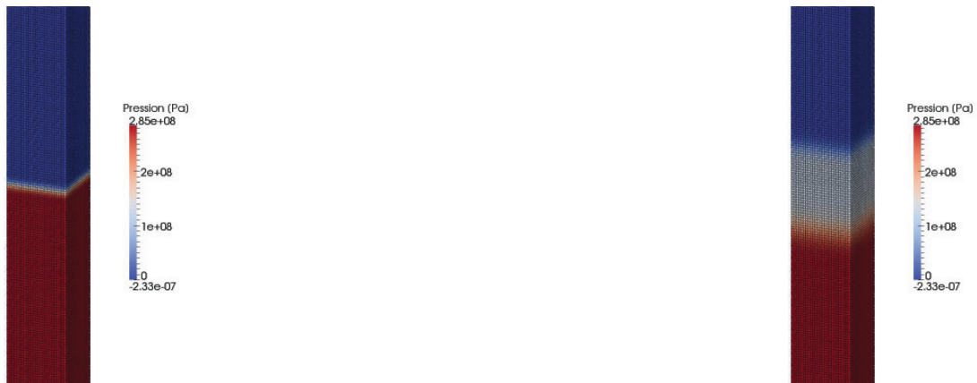
FIGURE 4.36 – Évolution de la pression cas du tube à choc - résolution 3D - Initiale à gauche et finale à droite
