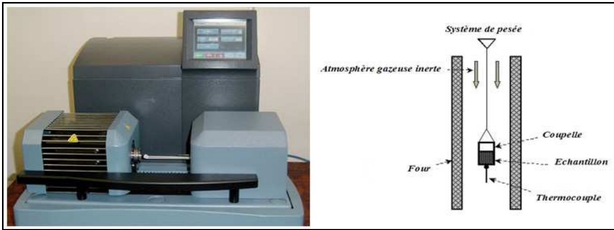
Figure II. 21. Appareillage et principe de la thermobalance.
