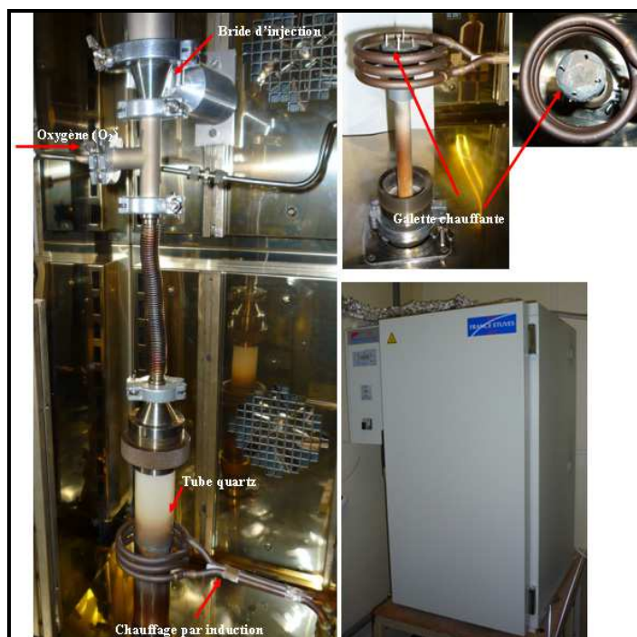
Figure III. 2. Schéma représentatif de la zone d'injection et de dépôt du réacteur MOCVD.
