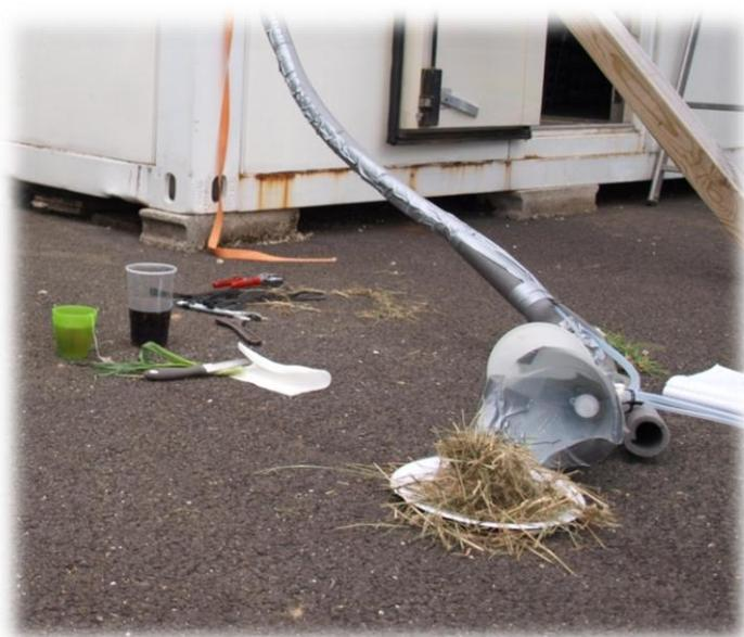
**Figure 3.20** : Positionnement des entrées des lignes de prélèvements des trois instruments (CRM-LSCE, CRM – MPI et FAGE)
