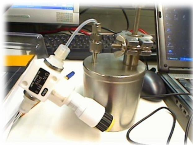
**Figure 2.13 :** Montage sous-pression pour tester la capacité du PTR-MS à réguler les faibles pressions extérieures
