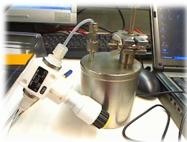
Figure 2.13 : Montage sous-pression pour tester la capacité du PTR-MS à réguler les faibles pressions extérieures
