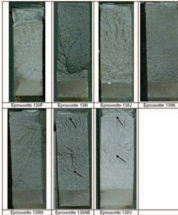
Figure E-13 : Macrographies des faciès de rupture - éprouvettes CT testées à  $-150^{\circ}\text{C}$ . Sur les éprouvettes 138AB et 138V, les deux arrêts de fissure sont matérialisés par des flèches noires.
