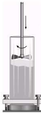
Figure 1- 18 : Rhéomètre à poudre [Luukkonen, 2001b].
