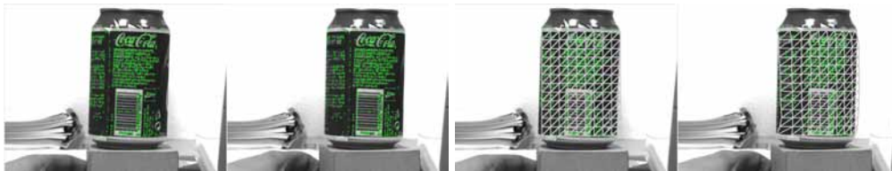
FIG. 4.1 – Déformation des splines après une légère rotation de d'une canette. haut : point d'intérêt appariés suivant SIFT - bas : estimation de la déformation de la grille
