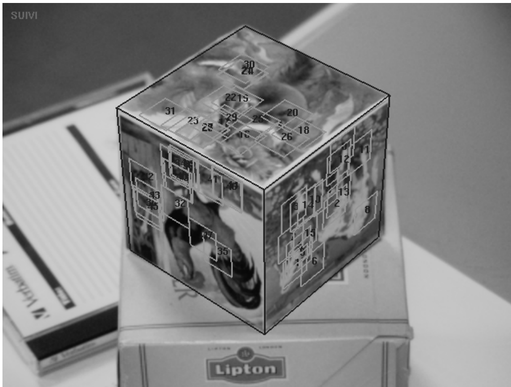
FIG. 3.1 – Exemple de répartition des patches à la surface d'un cube, répartition en fonction des points d'intérêt.
