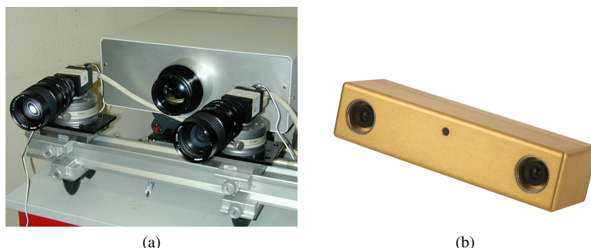
FIGURE 2.2 – (a) Configuration stéréo canonique sur notre système stéréo du prototype PICAS$O (Plateforme d'Intégration de CApteurs multi-Sen$Oriels), avec deux caméras dans le visible entourant une caméra thermique, (b) Système de stéréovision Bumble Bee2 fabriqué par Point Grey Research©.
