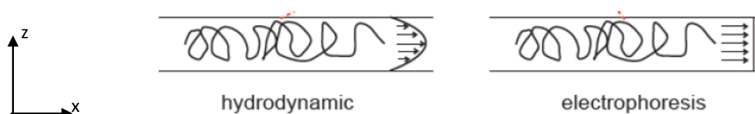
Figure IV.11 : Les profils des champs de force appliqués aux molécules dans le cas hydrodynamique et électrophorétique.
