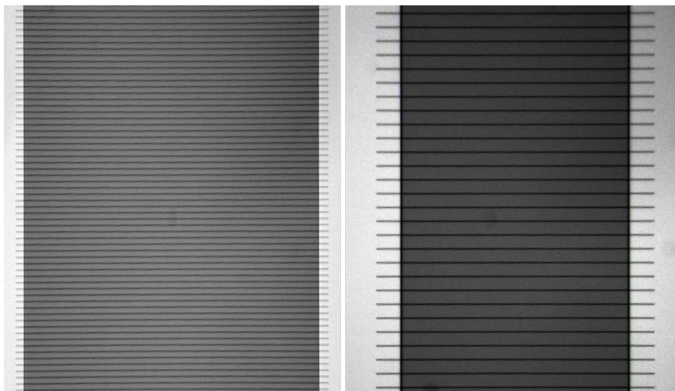
Figure II.14 : Photos au microscope optique de l'alignement entre le niveau « nanocanaux » et le niveau « canaux d'arrivée » sur deux cellules positionnées à des extrémités du wafer. ( gauche ) alignement observé sur la cellule située à l'extrémité haute et gauche du wafer (longueur des nanocanaux égale à 530 \mu\text{m} ) au grossissement x20. ( droite ) : alignement observé sur la cellule située à l'extrémité basse et droite du wafer (longueur des nanocanaux égale à 120 \mu\text{m} ) au grossissement x50.
