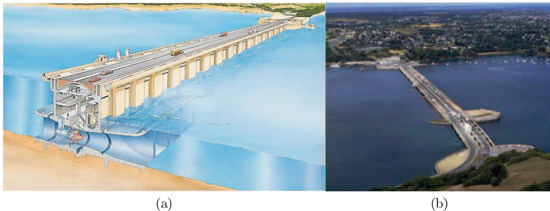
FIG. B.9: Schéma d'une centrale maremotrice et usine maremotrice de la Rance Schéma d'une centrale maremotrice(a) et usine maremotrice de la Rance (b).
