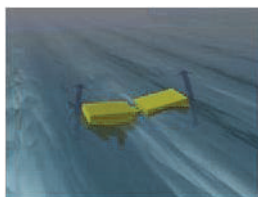
FIG. B.4: Atténuateur [Source : Aquaret].
