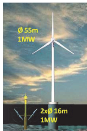
FIG. 1.5: Comparaison entre les géométries d'une hydrolienne et d'une éolienne fournissant la même puissance [Source : Jourden [18]].
