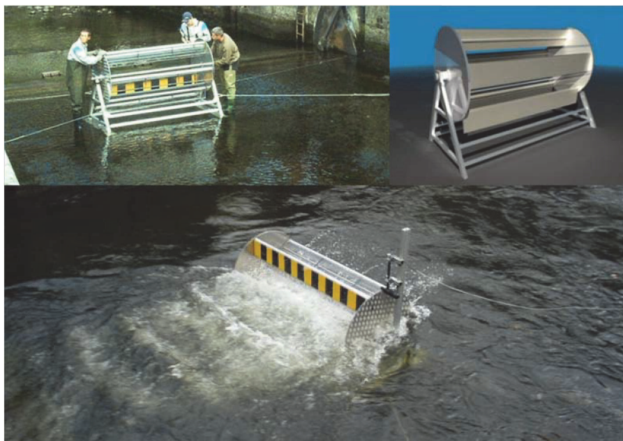
FIG. 1.4: Hydrolienne à flux transverse [Source : Atlantisstrom™, www.atlantisstrom.de ].
