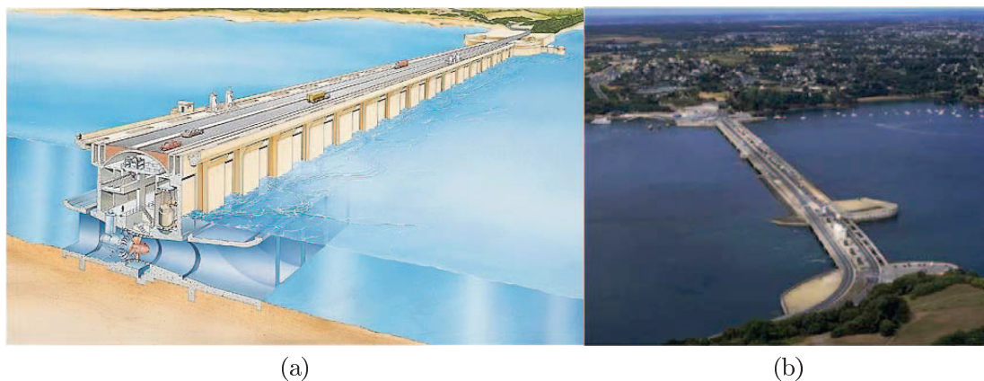
FIG. B.9: Schéma d'une centrale marémotrice et usine marémotrice de la Rance Schéma d'une centrale marémotrice(a) et usine marémotrice de la Rance (b).
