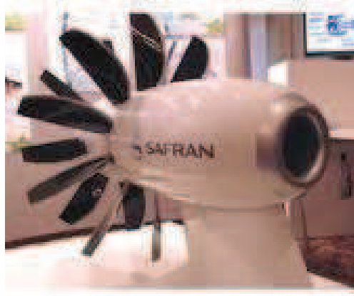
FIGURE 3 – Maquette Safran d'un nouveau type de moteur d'avion : l'Open rotor
