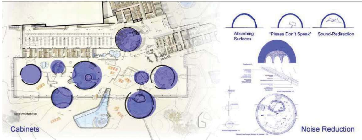
Illustration 58. Schéma en plans et coupes pour la recherche de la maîtrise de l'ambiance sonore 1
