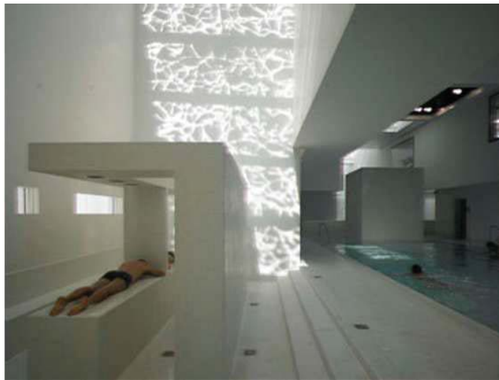
Illustration 37. Photographie de l'espace de balnéothérapie, vue sur les effets lumineux produits par les films placés sur les vitrages zénithaux 2
