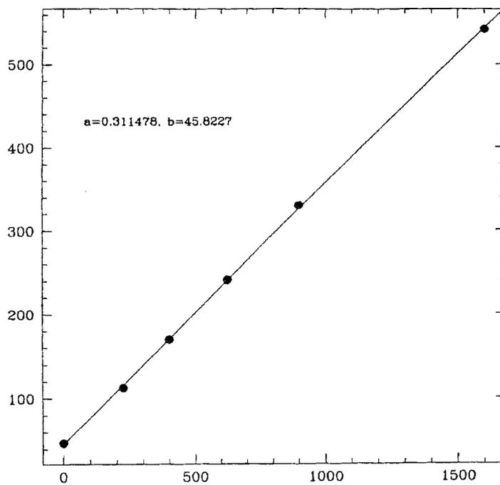
FIG. 3.3 –  $\sigma^2$  en fonction de  $(v \sin i)^2$ . Calibration du masque F0 pour la corrélation
