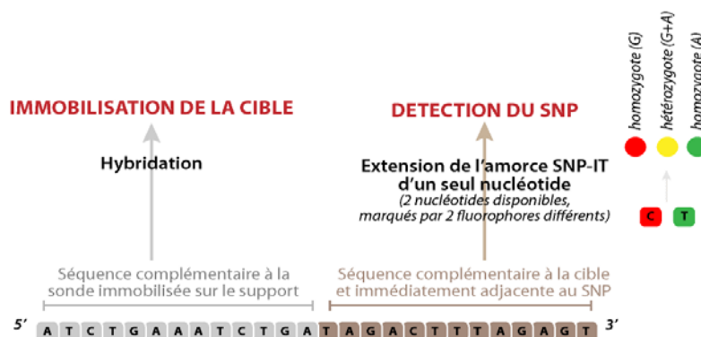
Figure 2-9 GenomeLab SNP Stream : structure du fragment utilisé pour l'élongation d'un nucléotide en cas d'appariement (un fragment spécifique par SNP)
