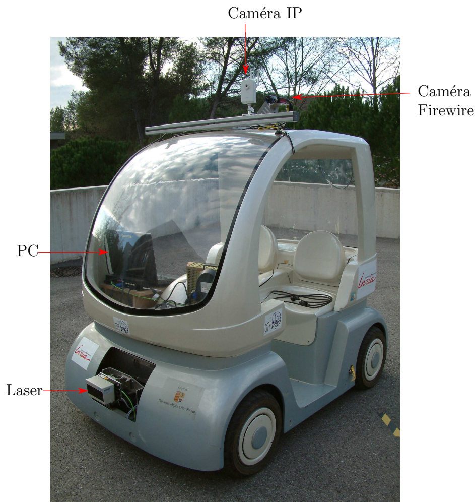
FIG. 8.1 – Véhicule Cycab et ses capteurs. La caméra Firewire est placée sur la galerie du véhicule. Le laser, positionné à l'avant, est utilisé pour détecter les obstacles à proximité du véhicule.
