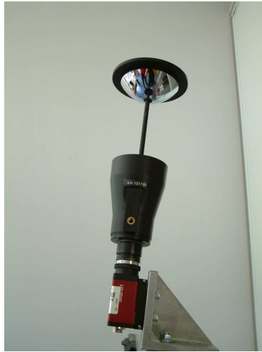
FIG. 3.2 – Caméra omnidirectionnelle catadioptrique.
