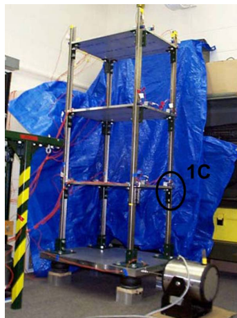
FIG. 4.2 Maquette métallique réalisée et testée au LANL ; Endommagement introduit sur l'assemblage 1C.
