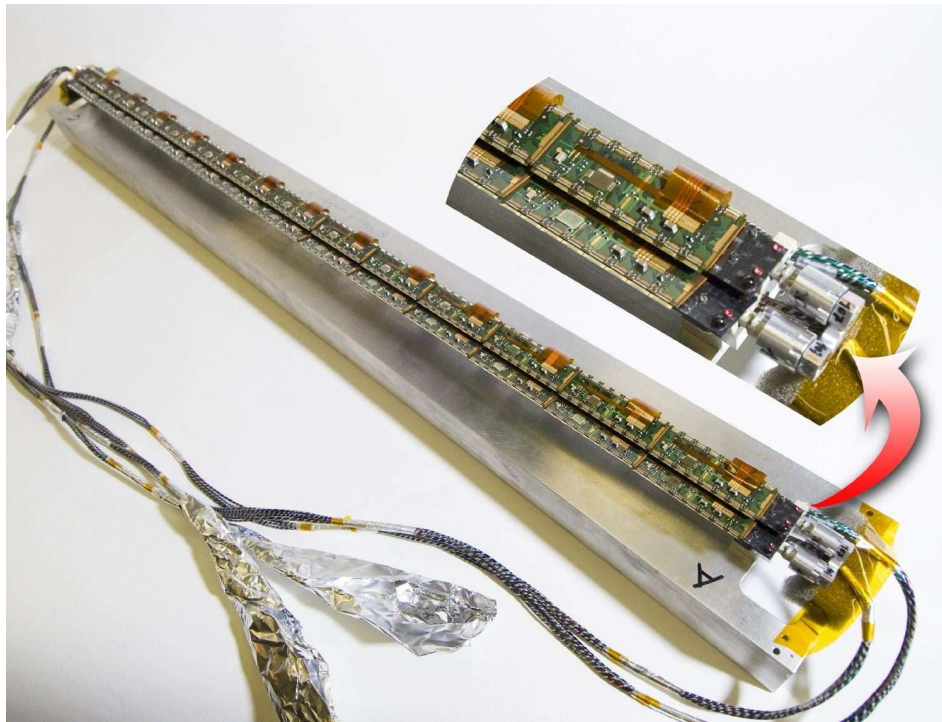
FIG. 6.4 – Double échelle du détecteur à pixels d’ATLAS. On distingue les treize modules qui forment chacune des échelles.
