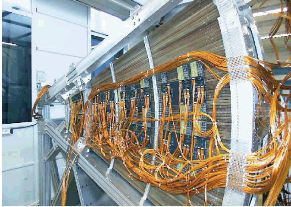
FIG. 5.23 – Vue de la face arrière du module 0. Seule la partie centrale était équipée en électrodes.
