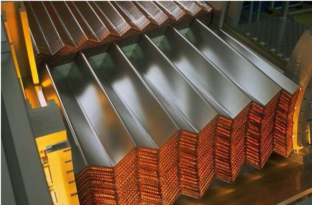
FIG. 5.3 – Détail de la région entre les roues externe et interne d'un module des bouchons. On distingue la directions radiale des plis.
