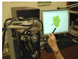
Interface haptique à 5 degrés de liberté [LAI-YUEN et al. 2006]
