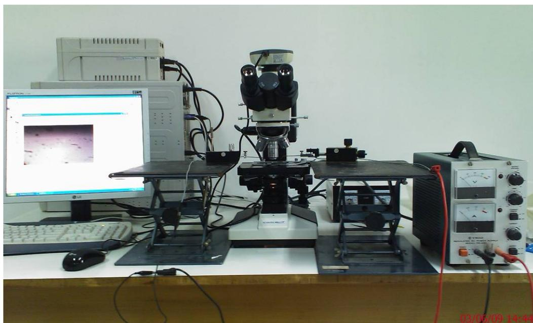
**Figure 7.** Photo du montage de mesure de l'électroactivité.
