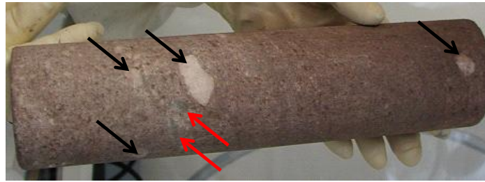
Figure 26. Echantillons EST31465 de la passe K2-20 carotté dans le Trias moyen. Les flèches noires indiquent certains éléments conglomératiques et les rouges l'emplacement de matrice argileuse facilement visualisable.
