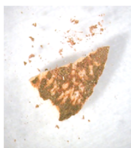
Figure 3-18: Photographies prises sous microscope montrant a) l'échantillon avant que l'assiette à dorer ne soit grattée du support, b) l'échantillon au cours de l'opération, c) un fragment du support obtenu après enlèvement de l'assiette à dorer
