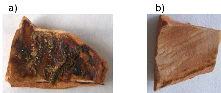
Figure 4-8: a) Photographie d'un morceau de céramique (40 x 25 mm) imprégnée d'anchois b) Photographie d'un fragment de céramique imprégnée (15 x 10 mm) dont la surface a été grattée et lavée à l'eau désionisée
