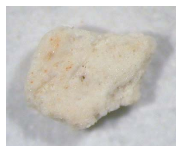
Figure 3-18: Photographies prises sous microscope montrant a) l'échantillon avant que l'assiette à dorer ne soit grattée du support, b) l'échantillon au cours de l'opération, c) un fragment du support obtenu après enlèvement de l'assiette à dorer
