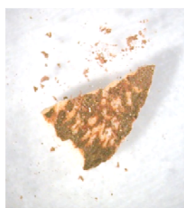
Figure 3-18: Photographies prises sous microscope montrant a) l'échantillon avant que l'assiette à dorer ne soit grattée du support, b) l'échantillon au cours de l'opération, c) un fragment du support obtenu après enlèvement de l'assiette à dorer
