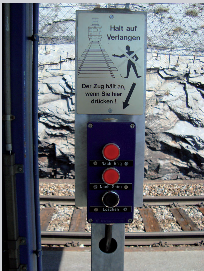
Photo 54. Système d'arrêt à la demande depuis le quai en gare de Hohtenn (ligne de faite du Lötschberg, rampe sud).
