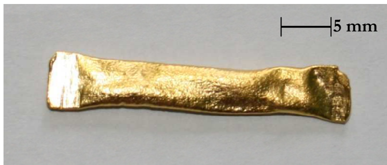
Figure 7.1 : Capsule en or fermée par soudure à l'arc électrique
