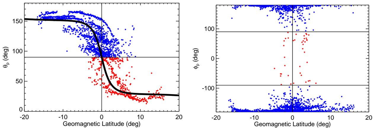
FIG. 4.21 – (à gauche) Angle polaire de la direction du vecteur de Poynting en fonction de la latitude géomagnétique. La ligne épaisse représente le résultat d’un modèle en utilisant la théorie du plasma froid (voir le texte). (à droite) Angle azimutal de la direction du vecteur de Poynting en fonction de la latitude géomagnétique. (d’après *Němec et al.* (2009c))
