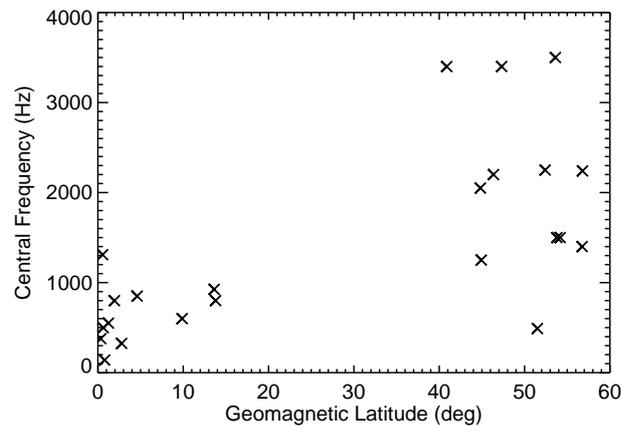
FIG. 4.6 – Fréquences centrales des événements MLR / des émissions électromagnétiques harmoniques dans la bande EBF en fonction de la latitude géomagnétique. (d’après *Němec et al.* (2007b))
