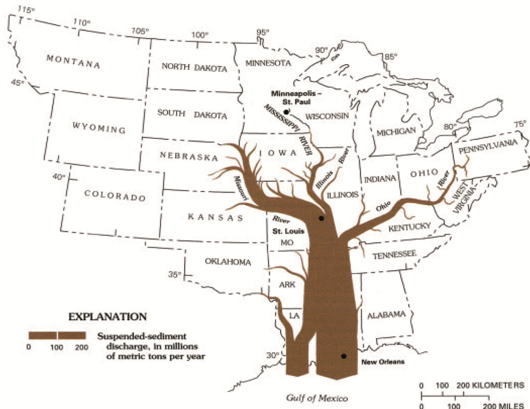
Figure I-10 : Flux annuels des sédiments en suspension du Mississippi et de ses principaux affluents (d'après Meade et Moody, 2010)
