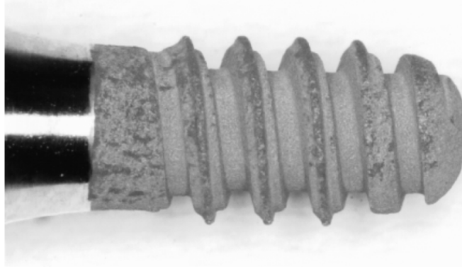
FIGURE 1.2 – Implant conique en titane utilisé par Berglundh et al. [11] et correspondant aux images obtenues figure 1.1. La rugosité de la partie filetée est visible à l'oeil nu.
