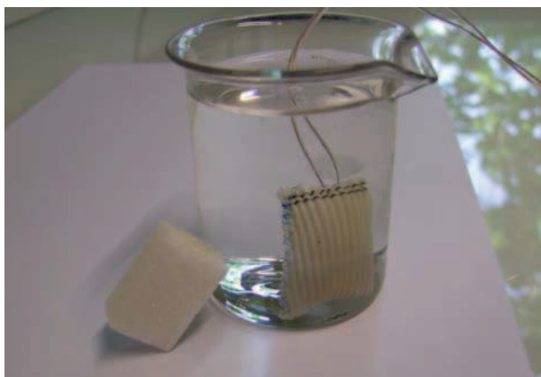
Figure IV-10: Pile insérée dans une membrane de Dacron®, immergée dans une solution de NaCl 0,15 \text{ mol.L}^{-1} , HEPES 25 \cdot 10^{-3} \text{ mol.L}^{-1} et glucose 5,5 \cdot 10^{-3} \text{ mol.L}^{-1} à pH = 7,2
