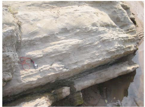
FIG. 3-36 Coupe du Rio Parapeti : grès à stratifications parallèles, finement laminés, à ciment calcaire.
