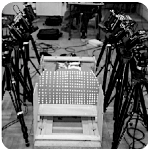
Figure 9. Dispositif de mesure des paramètres mécaniques d'une monopalme (Bideau et al. 2003).
