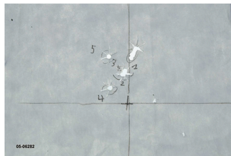
(b) Empreintes laissées par différents projectiles dans le panneau
