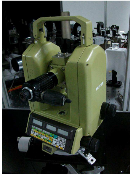
FIGURE 3.12 – Théodolite utilisé pour l’alignement.
