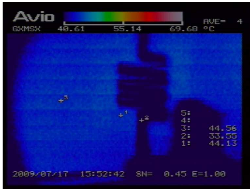
Figure 95 : Observation de la différence de température par caméra infrarouge T_{\max} = 45^{\circ}\text{C}
