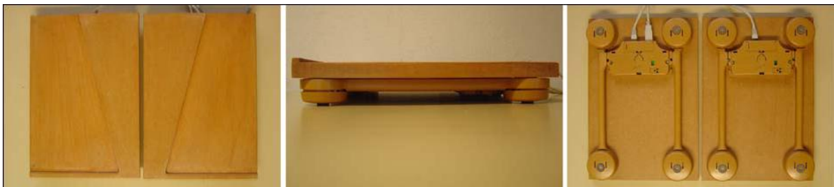
Figure 19 : Double plate-forme de force utilisée : Vue de dessus (gauche), Vue de profil (milieu), Vue de dessous (droite).
