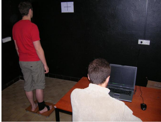
Figure 20 : Illustration du système d'évaluation du contrôle postural. Le sujet sera debout avec un pied sur chaque plate-forme de force. L'examineur, s'assurant du bon déroulement du protocole et de la saisie informatique.
