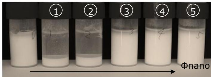
**Figure VI-21 Test de sédimentation des mélanges de microparticules de zircone (avec  $\Phi_{\text{micro}}=0.01$ ) en fonction de la concentration en nanoparticules de silice. Les photographies sont prises après 24 heures**
