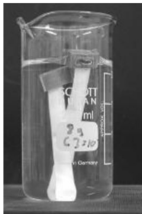
FIGURE 2.13: Image d'une compression osmotique en cours.
