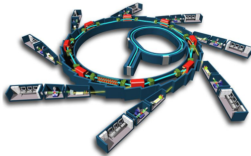
FIGURE 2.14: Schéma d'un synchrotron.
