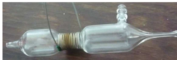
Figure 2.2 – Four utilisé pour étirer les fibres de chalcogénure. La résistance chauffante et le rétrécissement du diamètre du cylindre dans cette zone permettent de maintenir une température suffisamment élevée pour rendre la fibre visqueuse et pouvoir l'étirer. Un embout est prévu pour faire circuler un flux de gaz inerte et chasser l'air de la zone chaude.
