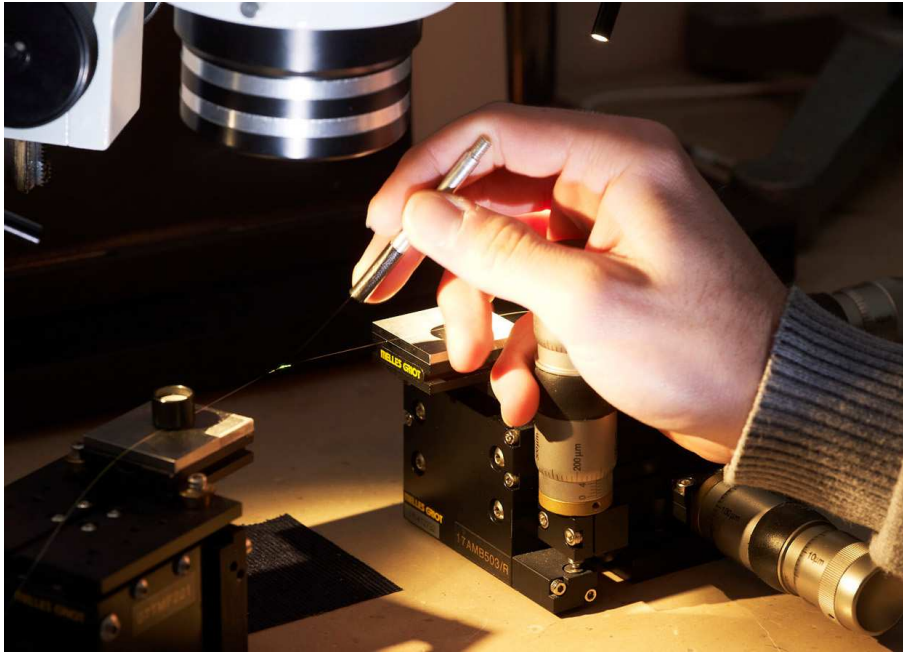
Figure 2.23 – Photographie de l’environnement de manipulation des microfibres optiques. Les deux extrémités non étirées d’une microfibre sont fixées sur des platines de micro positionnement, permettant la manipulation de celle-ci.
