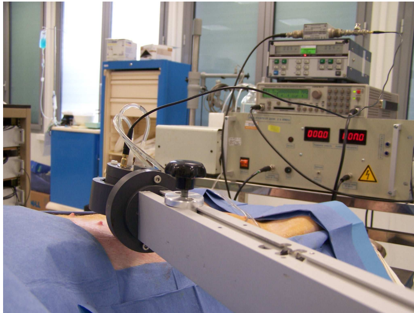
Figure III-1-3 : Montage expérimental avec en arrière-plan le générateur électrique et l'amplificateur de puissance, le power-mètre, le Watt-mètre, et la pompe de refroidissement.
