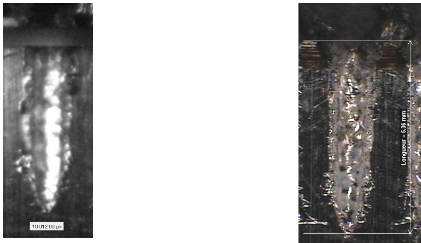
Figure II. 33 : Images du capillaire pour un impact de 10 ms et une puissance laser de 4 kW (observées (a) par camera rapide (b) par microscopie).
