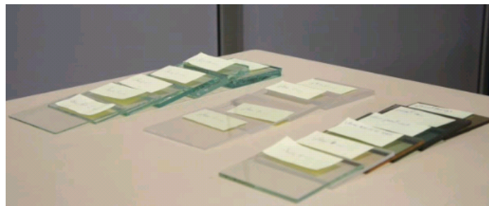
FIGURE 4.15: Plaques de matériaux utilisées pour l'analyse expérimentale par vision. Colonne 1 : Verre clair de différentes épaisseurs 2-3-5-6-10-12mm ; Colonne 2 : Plexiglas de différentes épaisseurs 2-3-5-6mm ; Colonne 3 : Différentes plaques de matériaux transparents de même épaisseur 4mm : verre clair, plexiglas, neoceram, vert parsol, gris parsol, bronze parsol.
