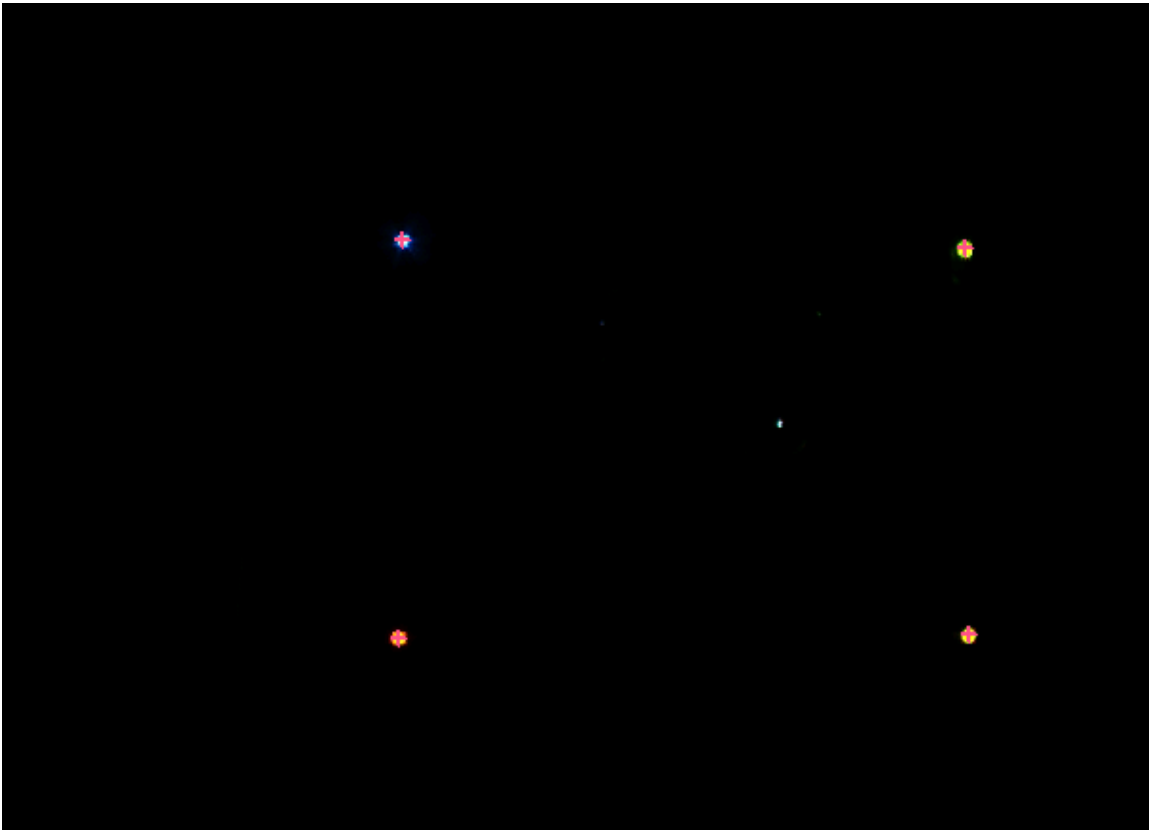
FIGURE 4.42: Illustration relative au "tracking" automatique du plan de référence. Les quatre croix rouge sont les points représentatifs de chaque diode définissant l'image du plan de référence pour une position donnée de l'objet.
