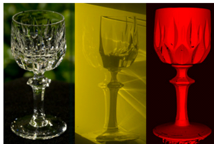
FIGURE 4.7: Reconstruction d'un verre transparent par son immersion dans un liquide fluorescent [Hullin et al., 2008].
