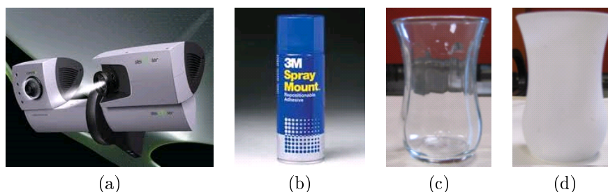
FIGURE 4.30: (a) Scanner 3D conventionnel Comet 5 Steinbichler; (b) La poudre matifiante utilisée; (c) Un exemple d'objet transparent à matifier; (d) L'objet transparent (c) opacifié avant le scanning par le scanner présenté à la Figure (a).
