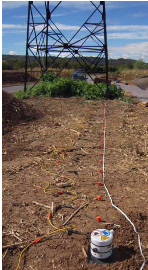
Figure 1.1 – Dispositif utilisé pour l’imagerie sismique des fondations de pylônes électriques avec la source vibratoire en premier plan et les géophones entre la source et le pylône électrique.
