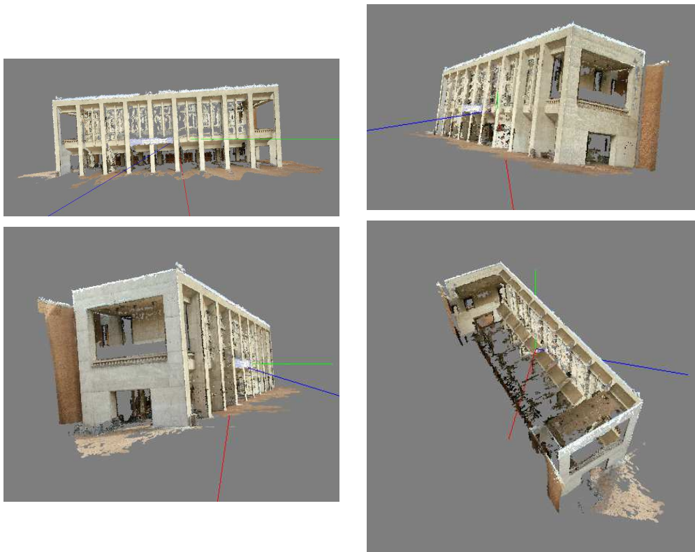
FIGURE 3.1.4 – Reconstruction 3D obtenue par l'utilisation de la chaîne de traitement de Furukawa avec les mêmes paramètres de calibrage que dans notre reconstruction 3.1.1.
