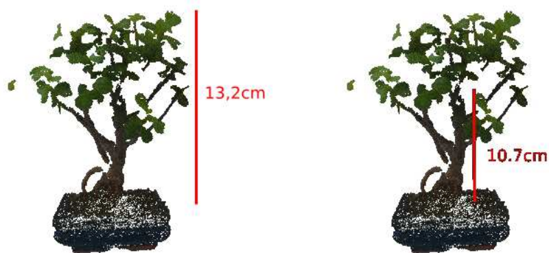
FIGURE 4.2.3 – Calcul de hauteur à partir de mesures effectuées sur le nuage 3D du bonsaï
