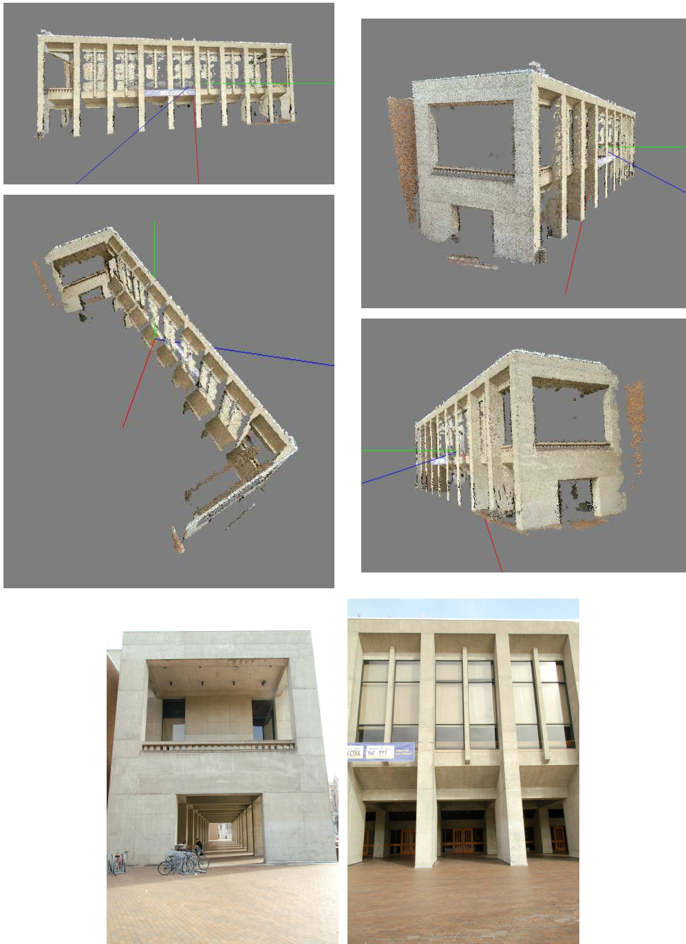
FIGURE 3.1.1 – Reconstruction d’un bâtiment avec notre chaîne de traitements à partir de 61 images. Les images de ce bâtiment données en exemple nous sont fournies par M.Furukawa.
