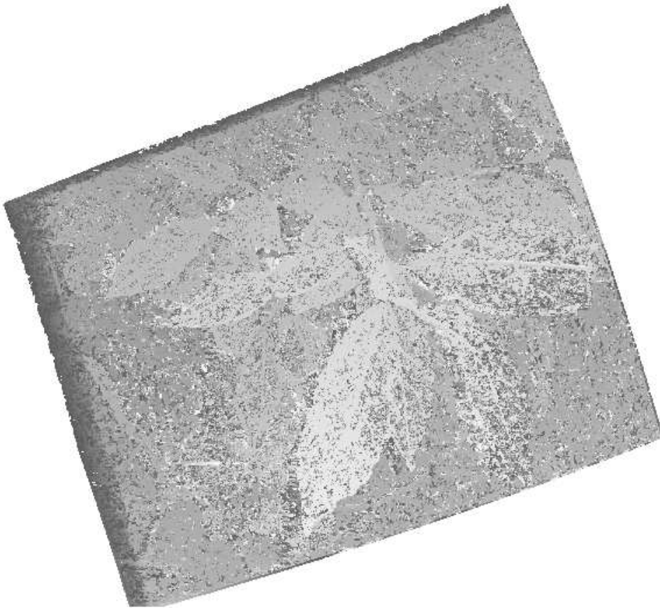
FIGURE 1.4.2 – Exemple de carte de disparité calculée avec une fenêtre 5x5 avec une similarité ZNCC
