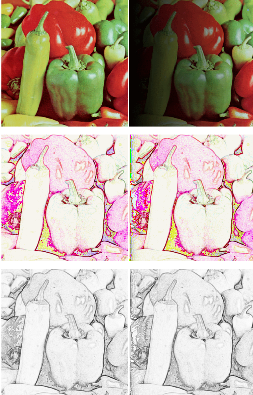
Fig. 4.29: Première ligne : image initiale peppers (à gauche), image assombrie (à droite), deuxième ligne : contraste correspondant, troisième ligne : norme correspondante
