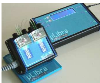
Figure I.2-13 : μLIBRA, appareil de mesure par QCM d'organismes génétiquement modifiés
