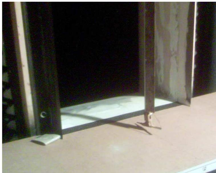
Figure II.13 – Mesure de vitesse au fil chaud. Le fil chaud et son support perturbent fortement l'écoulement et peuvent produire des sifflements rendant impropres les mesures aéroacoustiques.
