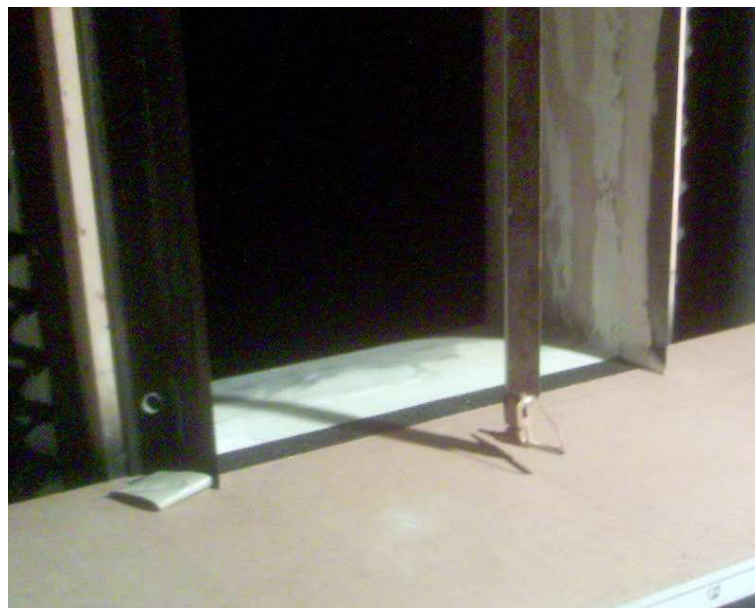
Figure II.13 – Mesure de vitesse au fil chaud. Le fil chaud et son support perturbent fortement l'écoulement et peuvent produire des sifflements rendant impropres les mesures aéroacoustiques.
